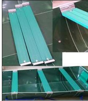
本体側に穴が空いていないので蝶ボルトで挟み込むように止めます。
