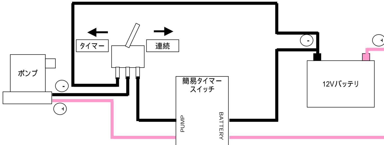
タイマースイッチはマイナス(-)側で電源を制御しているので、スイッチはマイナスのポンプ側に割り込ませてください。(バッテリー側ではない!!)
